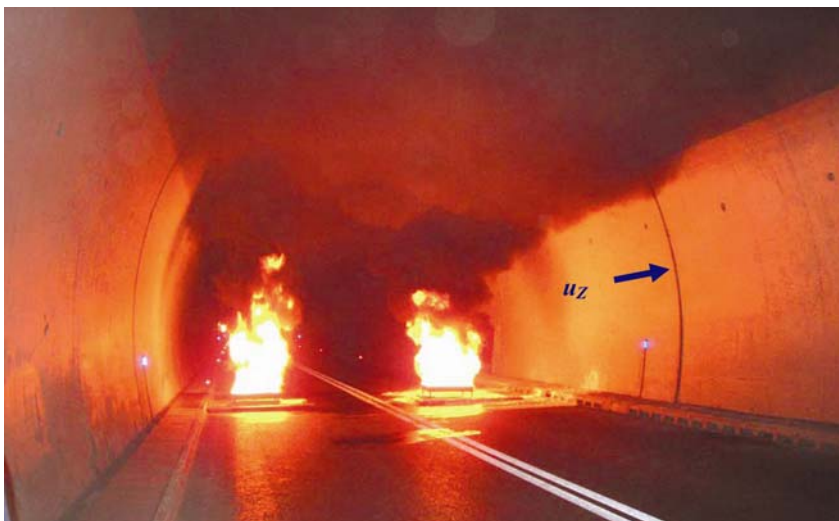
Stratifikacija (slojevito širenje dima u gornjoj zoni) u početnoj fazi požarnoga testa, pri kontroliranom održavanju uzdužne brzine zraka u intervalu od 1,0 do 1,5 m/s
